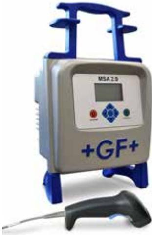
Das automatische Elektroschweisgerät MSA 2.0 verbindet dank der Inverter Technologie niedriges Gewicht mit hoher Leistungsfähigkeit. Das Gerät ist extrem einfach und schnell zu bedienen, lediglich drei Aktionen genügen um eine Schweißung auszuführen: Anschluss der Schweißkabel, Einlesen des Schweiß-Barcodes, Start der Schweißung.
