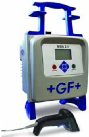
Das automatische Elektroschweißgerät MSA 2.1 verbindet dank der Inverter Technologie niedriges Gewicht mit hoher Leistungsfähigkeit, sowie eine Schweissdokumentation als PDF. Das Gerät ist extrem einfach und schnell zu bedienen: Anschluss der Schweißkabel - Einlesen des Schweiss-Barcodes - Start der Schweißung
