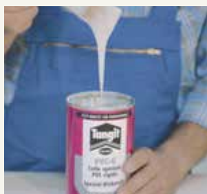
6. Tangit Klebstoff vor Gebrauch gut umrühren und das Ablaufverhalten prüfen.
