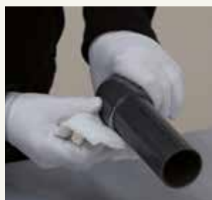
11. Überschüssigen Klebstoff mit Fließpapier entfernen.
