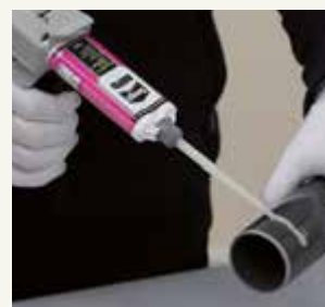
8. Klebstoff auf der Rohraußenseite auftragen.
