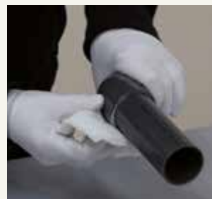
11. Überschüssigen Klebstoff mit Fließpapier entfernen.
